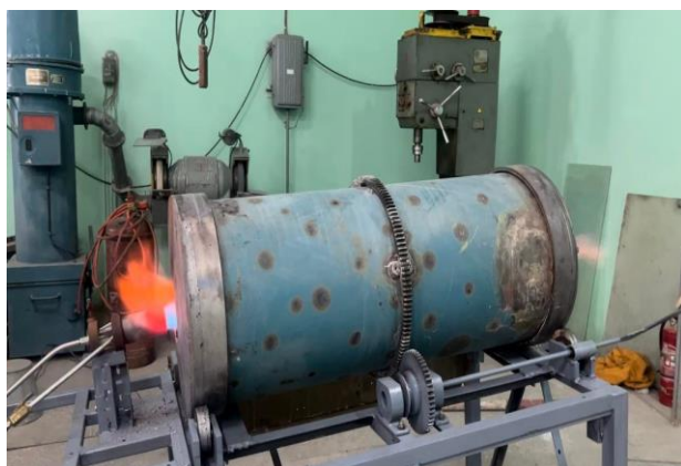
15-р зураг. Шохойн чулууг лабораторийн эргэх зууханд шатааж байгаа байдал
