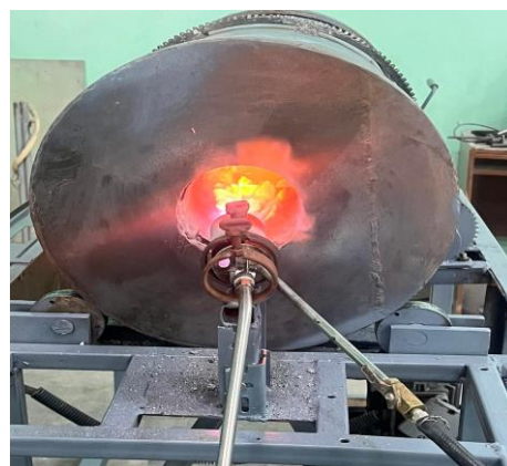
15-р зураг. Шохойн чулууг лабораторийн эргэх зууханд шатааж байгаа байдал
